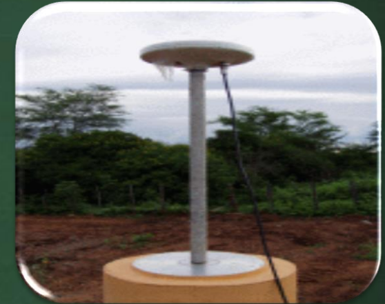
Exemplo de uso de GPS diferencial sobre marco geodésico
